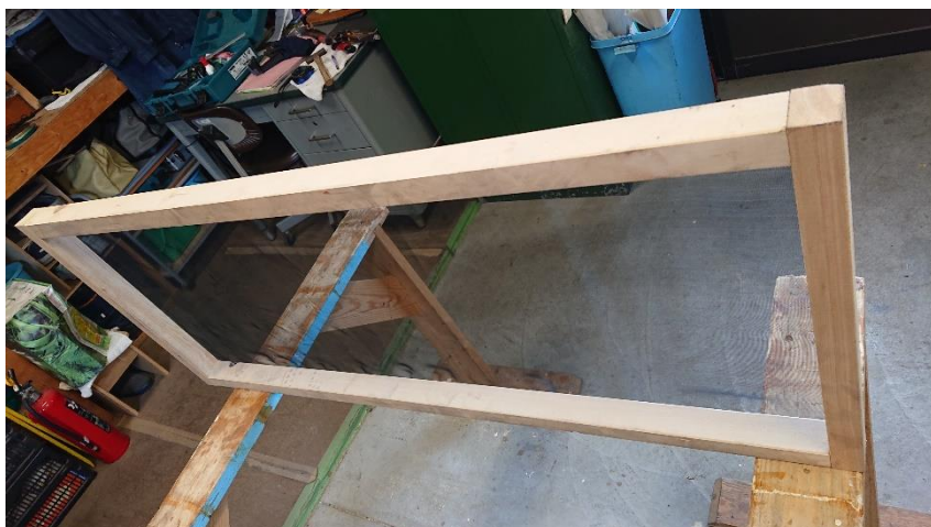
木枠に網戸を貼り付けて製作
