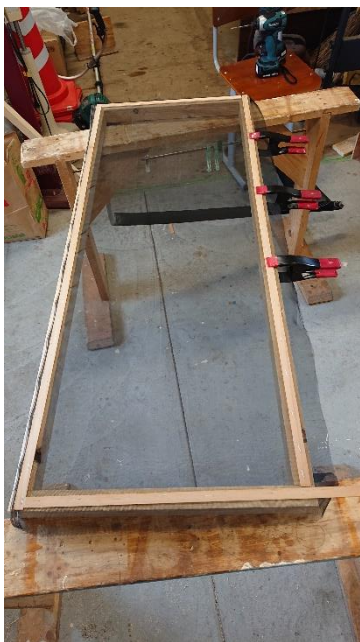
木枠に網戸を貼り付けて製作
