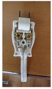
プラグへの芯線接続がこのような直接巻き付け 処理は、接触不良、断線焼損、短絡などの原因と なるので避ける
