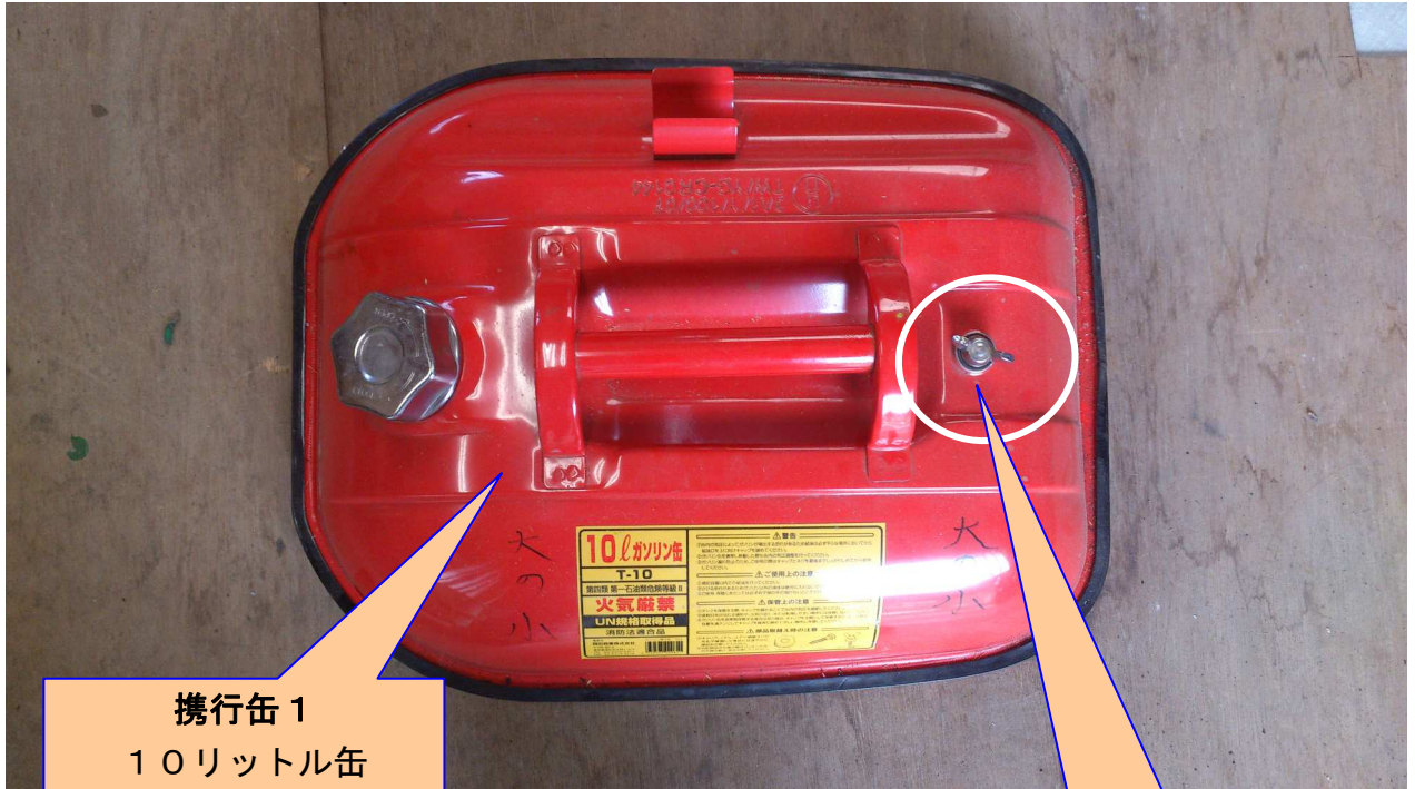
携行缶 2 携行缶のキャップを 開ける前には必ずこの 揮発抜きバルブを開放 してから行う事
